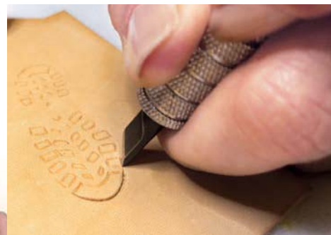
Gut 50 Schläge mit dem Punzereisen sind nötig, damit ein Quadratzentimeter Muster entsteht.
